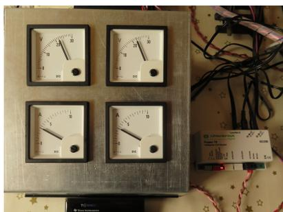
Die Strommesser sind ein wichtiger Indikator bei der Abschaltung nach langen Messphasen. Die Anzeige schwankte je nach eingestelltem Leistungswiderstandsbereich zwischen jeweils 2,5 A bis
