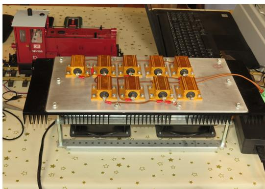
3,4 A (3.5 A). Bei Überlast und simuliertem Kurzschluss war natürlich ein kurzzeitig höherer Ausschlag sichtbar. Ein reales Messergebnis konnte durch die Verwendung gekühlter Hochleistungswiderstände erreicht werden, indem es möglich wird, die anliegende Impulsspannung (Spannungshubhöhe) mit nur einem kleinem Messfehler zu bestimmen. Dazu wurden neun Hochleistungs-Drahtwiderstände (2,2 Ohm, 75 Watt Verlustleistung) auf einer
